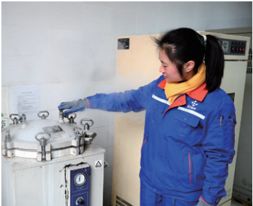
5. 程晓芸检查灭菌使用的高压锅放空阀
