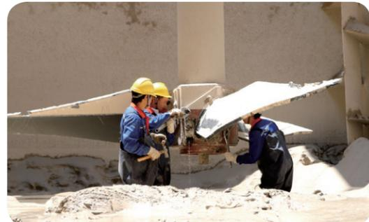
检修人员对浮选精矿槽搅拌机桨叶进行修理 (图 / 徐依伊)
