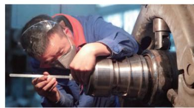
由于煤烧嘴长期在高温、高压环境下运行,使用寿命短,修复要求的精度高,难度大,多年来水富云天化煤烧嘴都是由外部专业公司维修,其维修技术保密且维修成本较高。去年10月,维保事业部按照水富云天化要求专门成立了技术攻关小组以解决气化炉煤烧嘴修复的技术难题。
